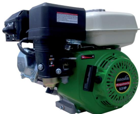
Disponemos de varios tipos de cigüeñal para adaptar a generadores, motoazadas, motobombas, etc. Motor estacionario de 168FA 5.5 HP, con sistema OHV (válvulas a la cabeza), de eje horizontal con arranque manual y alerta de aceite que hace detener el equipo en caso de bajo nivel de aceite. Por sus características este motor puede ser aplicado en compresores de aire, generadores y bombas, hidrolimpiadoras, kartings, equipo para agricultura, martillos, etc.
