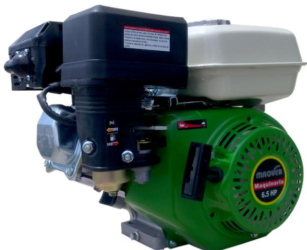
Motor estacionario de 168FB 6.5 H.P, con sistema OHV (válvulas a la cabeza), de eje horizontal con arranque manual y alerta de aceite que hace detener el equipo en caso de bajo nivel de aceite. Por sus características este motor puede ser aplicado en compresores de aire, generadores y bombas, hidrolimpiadoras, kartings, equipo para agricultura, martillos, cortadoras de disco, etc.
