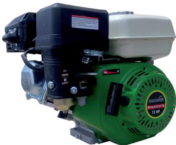
Motor estacionario de 4 tiempos de 13 HP, con sistema OHV (válvulas a la cabeza), con arranque eléctrico y manual y descompresor que facilita su arranque. Con alerta de aceite que hace detener el equipo en caso de bajo nivel de aceite.
