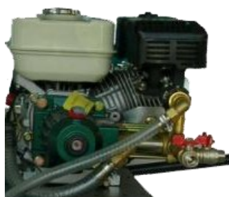
DETALLE BOMBA CON MOTOR
